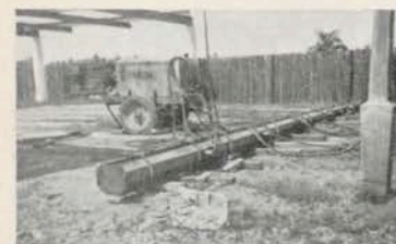
Fig. 3. Vervaardiging van een trilbeton-mast in ijzeren bekisting en met uitwendige trilling.
